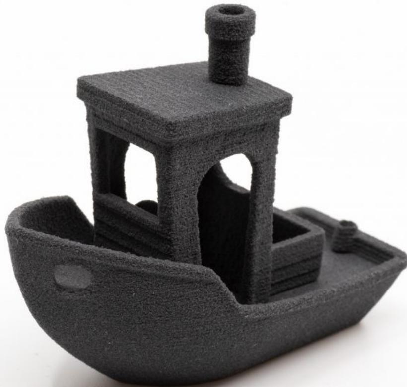
SLS技術で知られる従来の単一焦点レーザービームの代わりに、独自のDLPベースの強力なIR光学エンジンを使用することで、印刷速度、解像度、造形領域を大幅に向上させます。ビジテックは、広く使用されている選択的レーザー焼結 (SLS) 技術の制限を解消し、産業用アプリケーションのより良い候補として粉末床溶解結合法 (PBF) を開発することを目指しました。これを達成するには、高スループットと高解像度が必要です。
